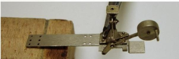
Der jetzt komplette Stellbock wird nun auf das Schwellenlagereisen aufgelötet. Regelmäßig wird der Stellbock auf der geraden Seite der Weiche angeordnet.
