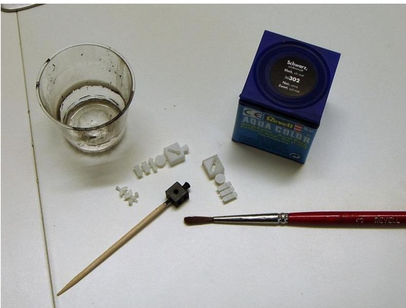
Die Weichenlaternen sind aus Acryl (Plexi) im 3D-Druckverfahren hergestellt. Hierdurch haben die Streuscheiben das charakteristische Aussehen von Milchglasscheiben bzw. von reflektierenden Einsätzen.
