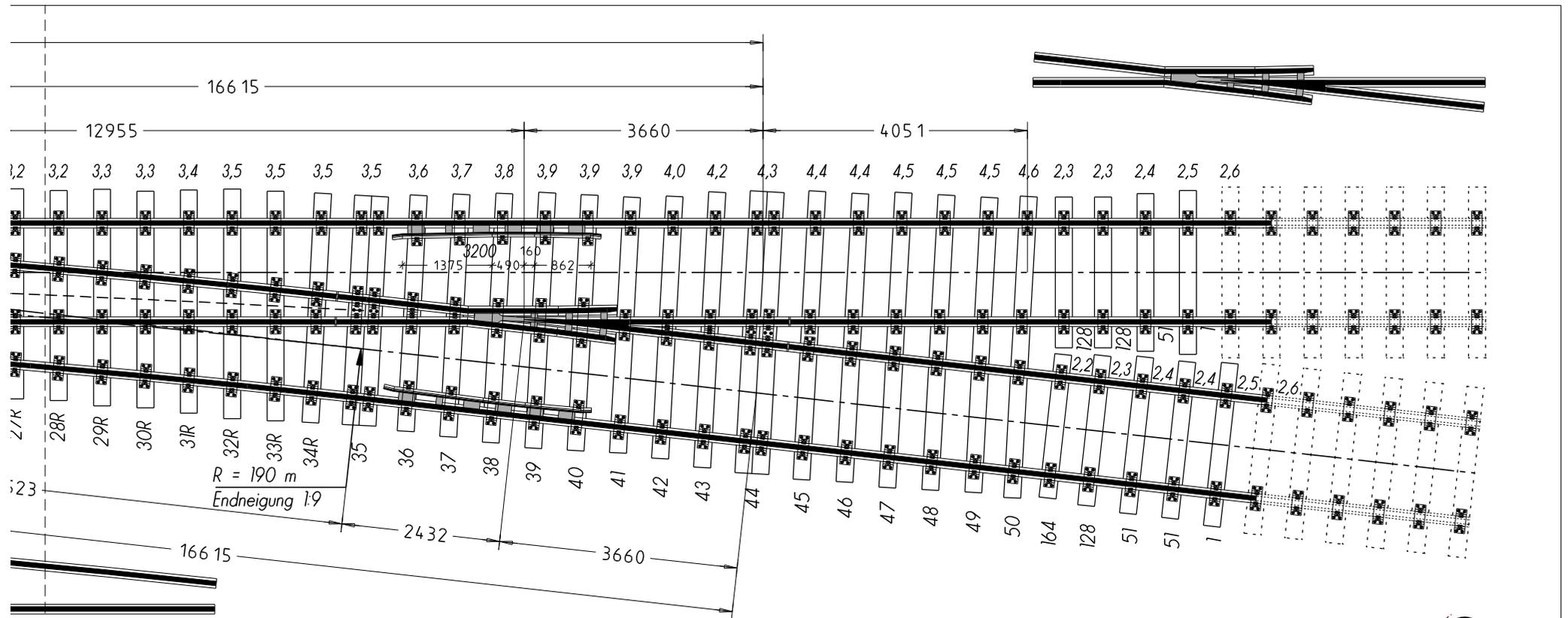
g) Ausführung mit Schienenstützen Stü7 (ältere Bauart), Herzstück geschweißt n. Blatt 4f, 3,20 m Radlenker aus Profil RI 1-49
