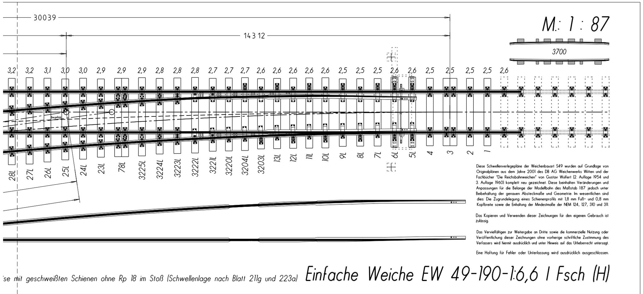
...se mit geschweißten Schienen ohne Rp 18 im Stoß (Schwellenlage nach Blatt 211g und 223a) Einfache Weiche EW 49-190-1:6,6 I Fsch (H)
