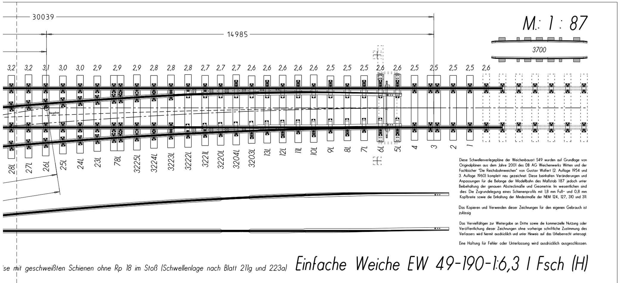
...se mit geschweißten Schienen ohne Rp 18 im Stoß (Schwellenlage nach Blatt 211g und 223a) **Einfache Weiche EW 49-190-1:6,3 I Fsch (H)**
